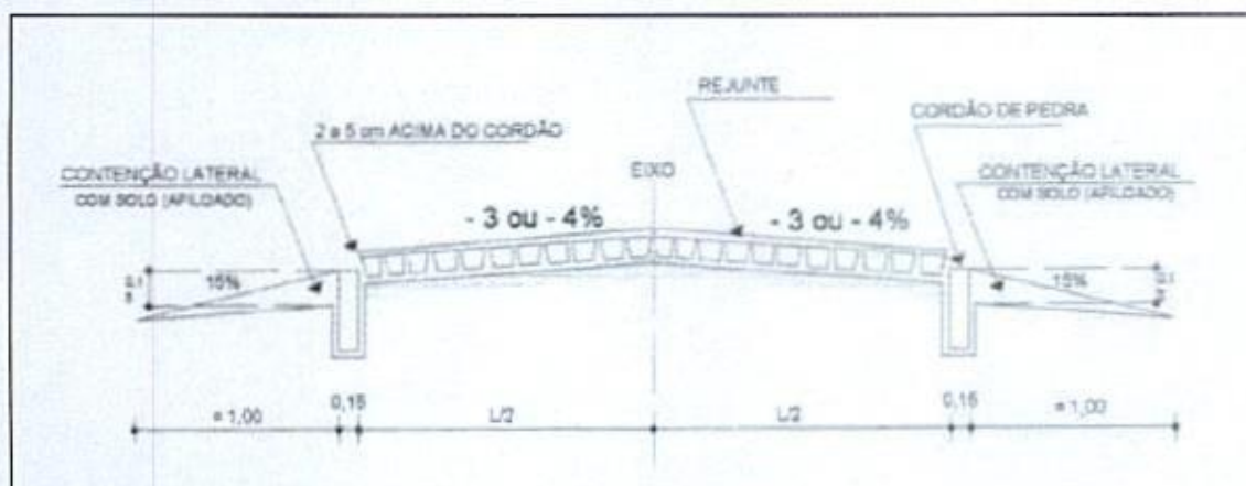
Figura 13: Assentamento das Pedras
